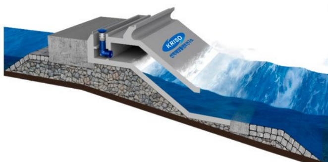
Figura 2.6 – WEC do tipo coluna de água oscilante (OWC). Adaptado de [34].
