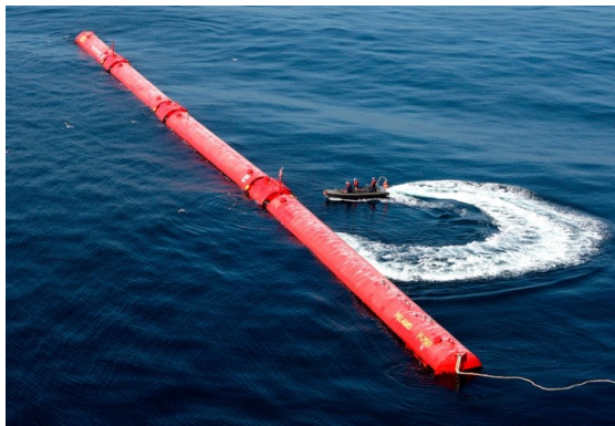
Figura 2.3 – WEC do tipo atenuador da energia das ondas. Adaptado de [31].
