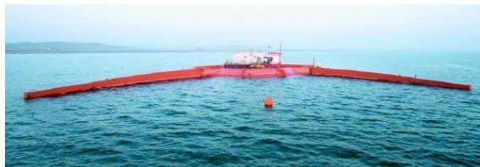
Figura 2.5 – WEC do tipo sobre-elevação de ondas (Wave Dragon). Adaptado de [33].
