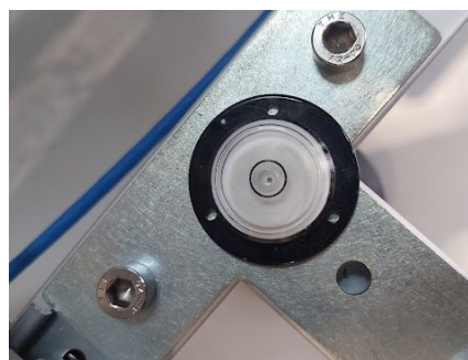
Figura 3.39 – Nível utilizado para nivelar a estrutura da bancada de testes.
