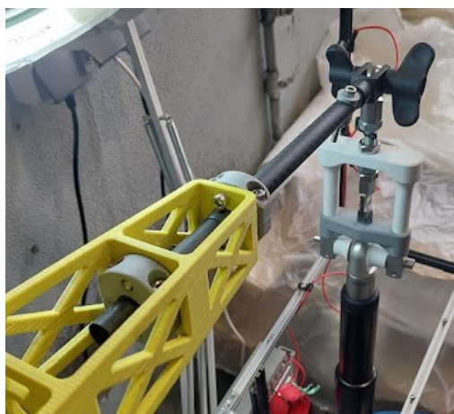
Figura 3.42 – Ligação entre o braço exterior e o atuador elétrico.
