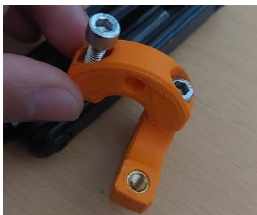
Figura 3.36 – Pormenor de inserts introduzidos nas peças impressas.
