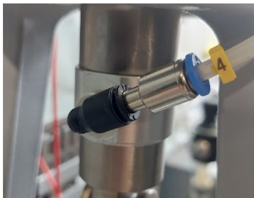
Figura 3.46 – Ligação pneumática ao atuador pneumático.
