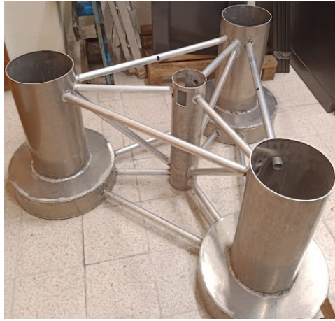
Figura 3.32 – Fabricação da plataforma à escala.
