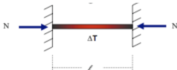
Figura 2.8 - Carril biencastrado submetido à variação de temperatura [Silva, 2004]
