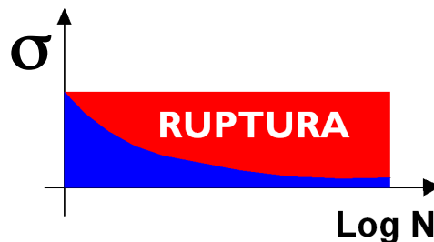
Figura 2.7 - Relação entre a tensão máxima suportada pelos materiais metálicos e o número de ciclos de carregamento [adaptado de Silva, 2004]
