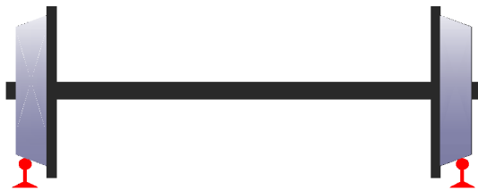
Figura 2.2 - Roda alinhada com o carril [adaptado de Silva, 2004]
