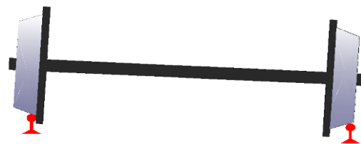
Figura 2.3 - Efeito de escorregamento [adaptado de Silva, 2004]
