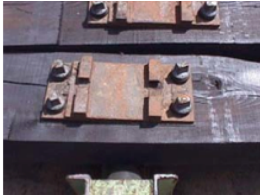
Figura 2.12 - Chapim metálico [Silva, 2004]
