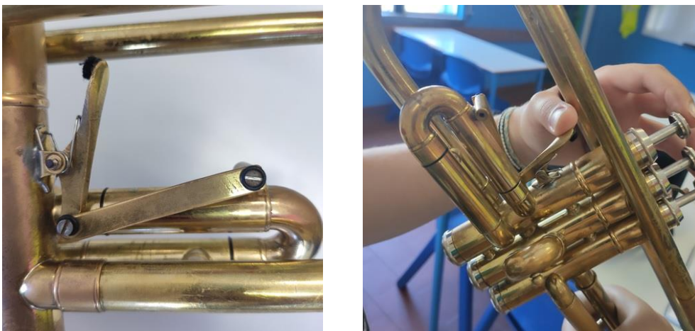
Figura 38. Sistema alavanca em mola desenvolvido para a aluna em estudo.
