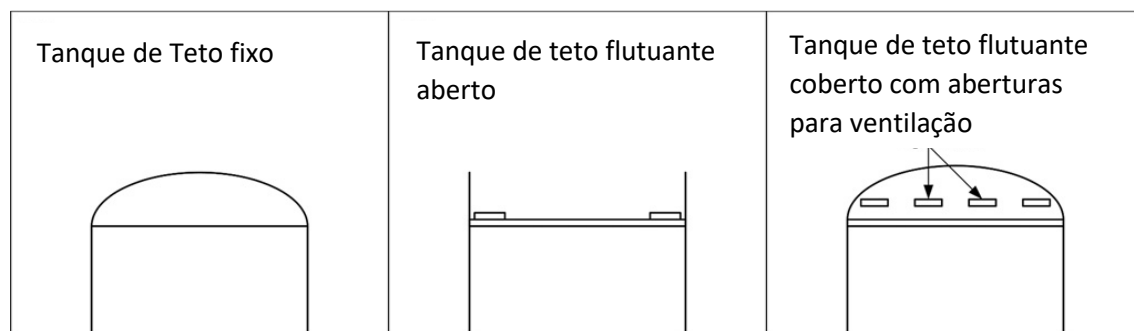
Figura 13 - Tipos de teto de tanques
