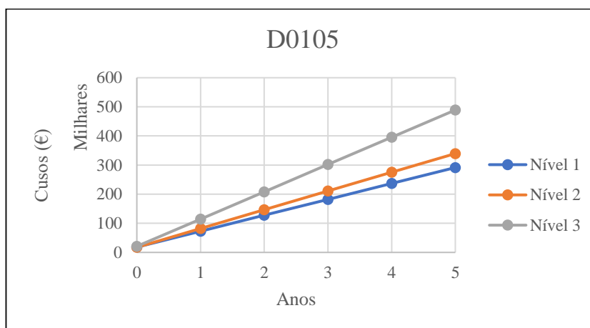
Figura 17 - Custos de investimento e operação para cada nível de blanketing do D0105
