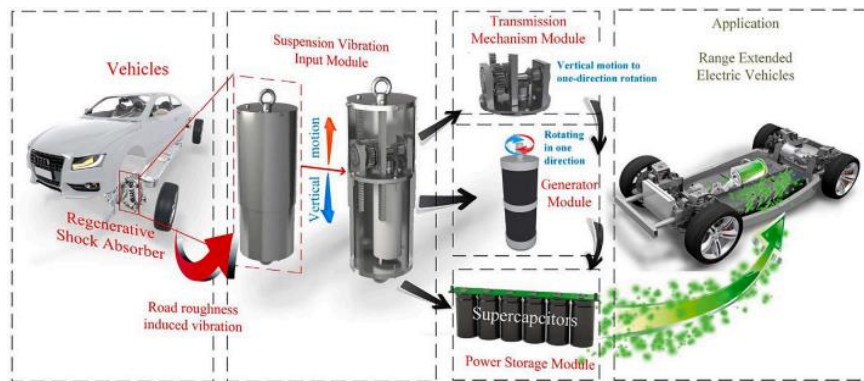
Figura 3.25 – Esquema de uma proposta de regeneração de energia numa suspensão de um carro (Zhang, Z. T. et al., 2016).
