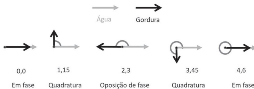
Figura 9 – Representação dos vetores de magnetização transversal da água e da gordura em aquisições com diferentes TEs (ms), tendo como referência a frequência da água num equipamento de 1,5T.
