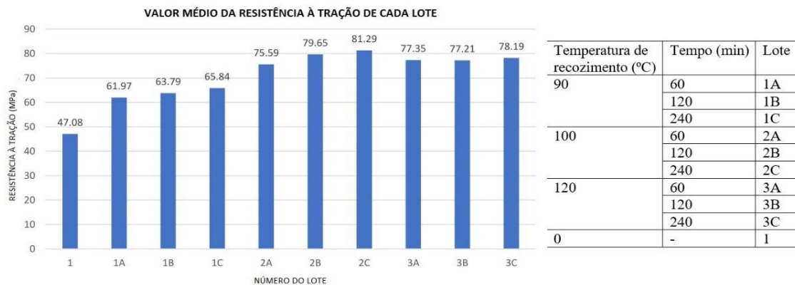
Figura 27 – Influência do recozimento no valor médio de resistência à tração, adaptado de [51].
