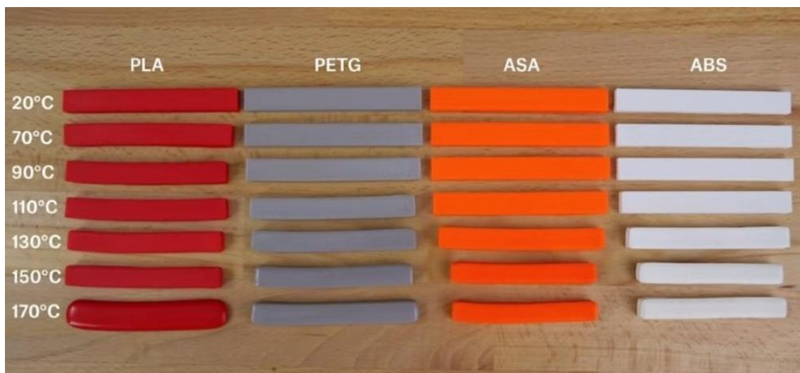
Figura 25 – Exemplos de mudanças dimensionais após o recozimento [48].
