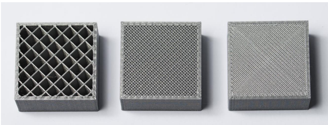
Figura 10 - Densidade de enchimento variando de 20% (esquerda), 50% (meio) e 75% (direita) [24].
