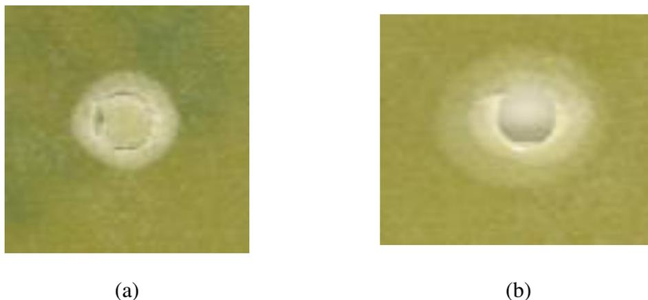
*Figura 49 – Scan de dois furos efetuados com os parâmetros P1 na placa 10B com a ferramenta BZT03
