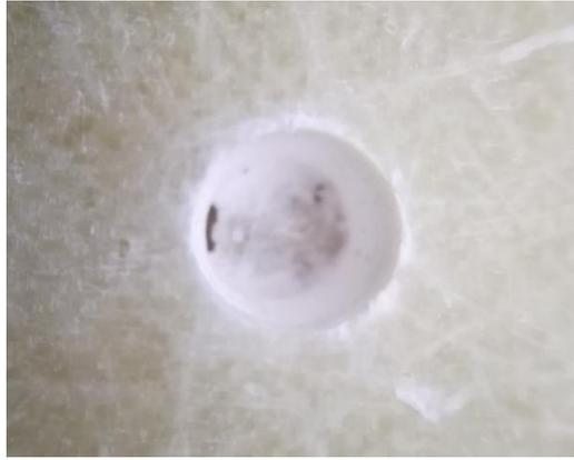
Figura 54 – Furo após eliminar o excesso superficial do fluido de contraste.
