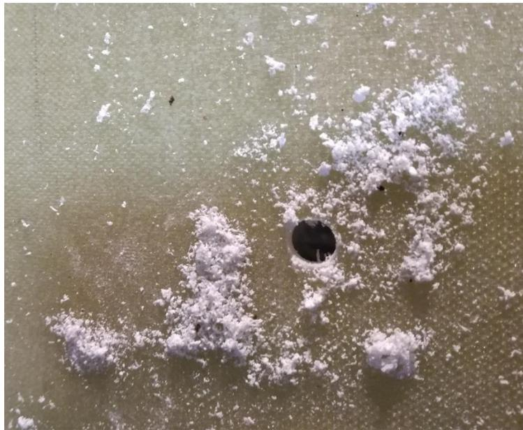
*Figura 62 – Aparas que se acumulam em torno do furo durante o processo de furação.*
