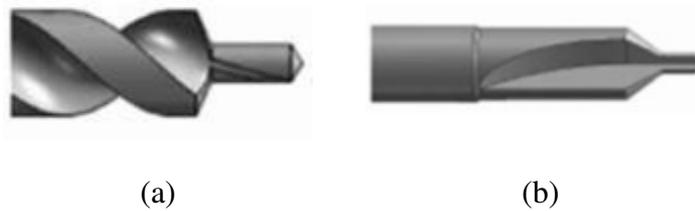
Figura 26 - Broca bidiametral (a) helicoidal; (b) dentes diretos (Gonçalves 2011).
