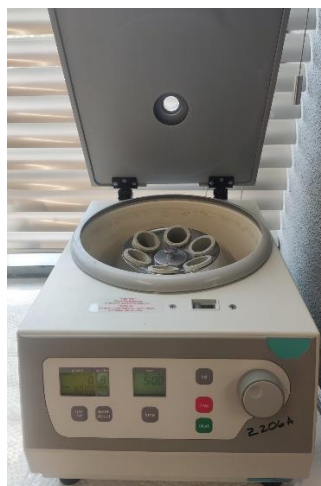
Figura 27 – Centrífuga Hermle, Z206A.
