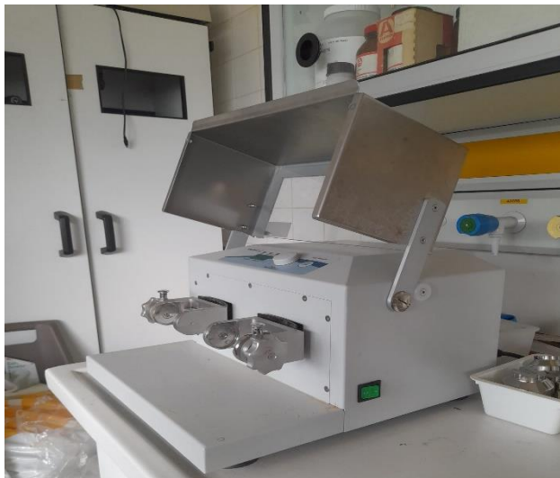
Figura 16 – Moinho de bolas de agitação, VWR Star Beater.
