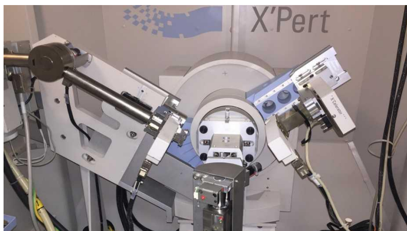
Figura 19 – Difrátometro de raios-X.
