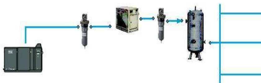
Figura 4.38 – Exemplo de Secagem antes dos Reservatórios [16].
