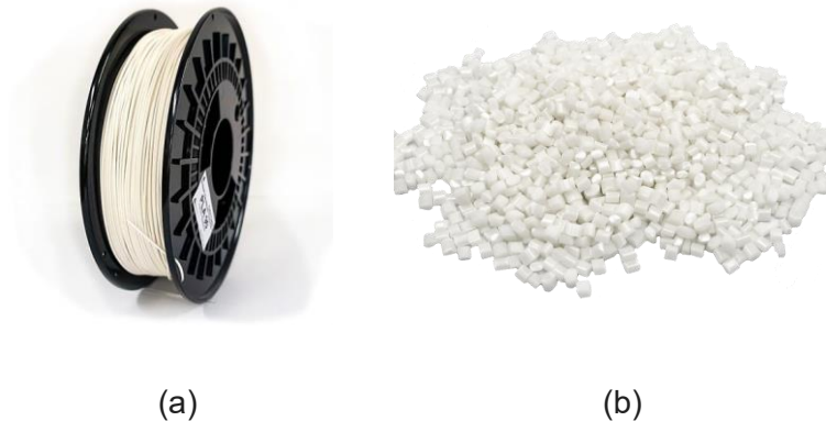
Figura 2.10. PLA para impressão 3D: (a) No formato de filamento, (b) Em pellets ( filament2print, 2025 ).
