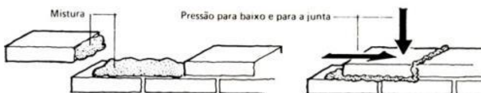
FIGURA 4.16 – VASSENTAMENTO DE FIADA DE TIJOLO [1]
