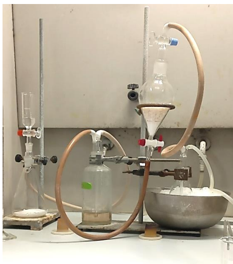
Figura 3.2 - Montagem para síntese do Ácido Clorídrico Etéreo (3M).
