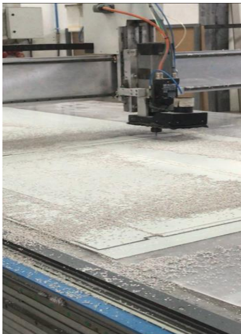
Figura 4.5 – Corte na máquina CNC (Fonte: Arquivo Próprio)
