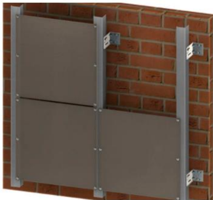
Figura 3.4 – Pormenores de Aplicação de Materiais com a Fixação através de Rebites (Fonte: ARCHIEXPO)
