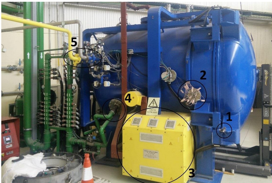
Figura 18. Constituintes do forno TAV.
