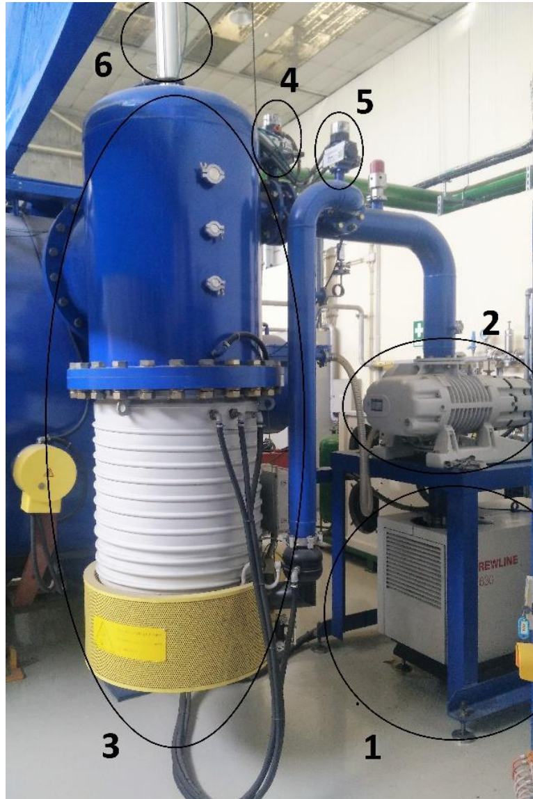
Figura 20. Constituintes do forno TAV.
