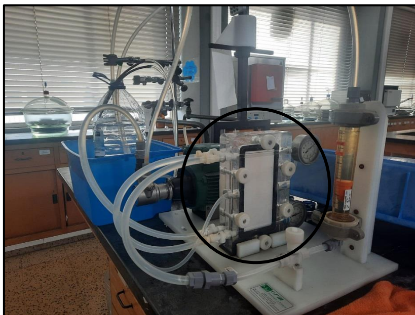
Figura 2.2-1 - Módulo de filtração
