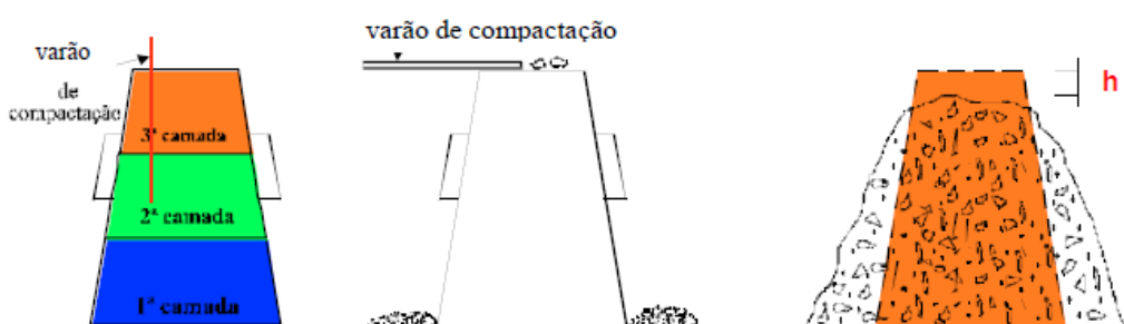
Figura 83: Execução do Ensaio de Abaixamento ou Slump
