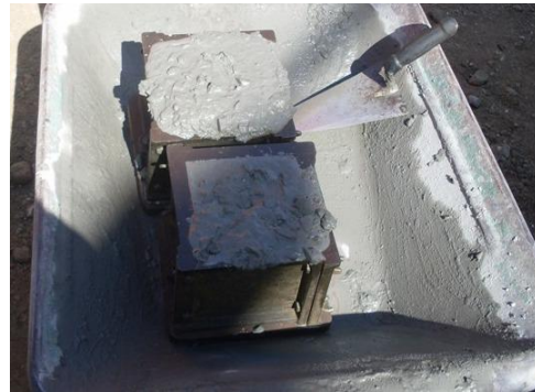
Fig.69 Enchimento dos cubos
