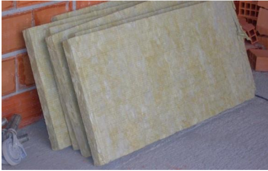
Figura 36 - Lã de Rocha (isolamento térmico)
