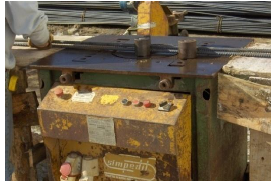
Fig.96 - Máquina de dobragem de varões de aço
