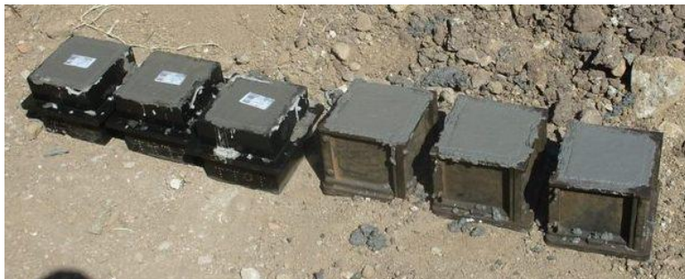
Fig.70 Seis cubos preenchidos com betão e preparados para serem transportados para o laboratório
