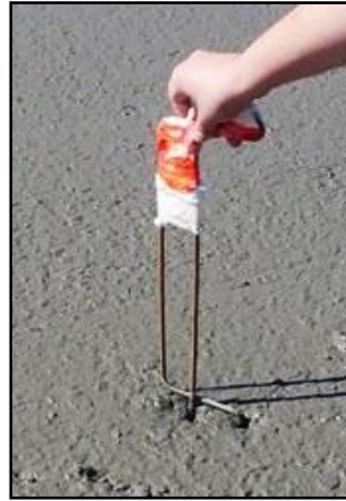
Fig.54 Bitola de espessuras de betão em pavimentos
