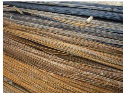
Figura 15- Varão A400 NR entre 6 e 16 mm e Arames de Aço recosido para betão
