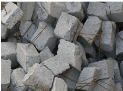
Figura 21 - Calços/Espaçadores de betão
