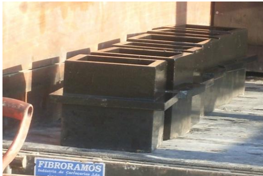
Fig.68 Seis cubos vazios para o seu enchimento de betão
