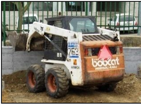
Fig.41 Pá carregadora de pneus de pequeno porte - Bobcat
