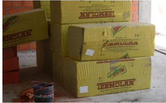
Figura 37- Lã de rocha de 4,5 e 6 cm de espessuras e de peso volúmico 70 kg/m 3
