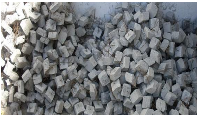
Fig.78 Espaçadores de betão
