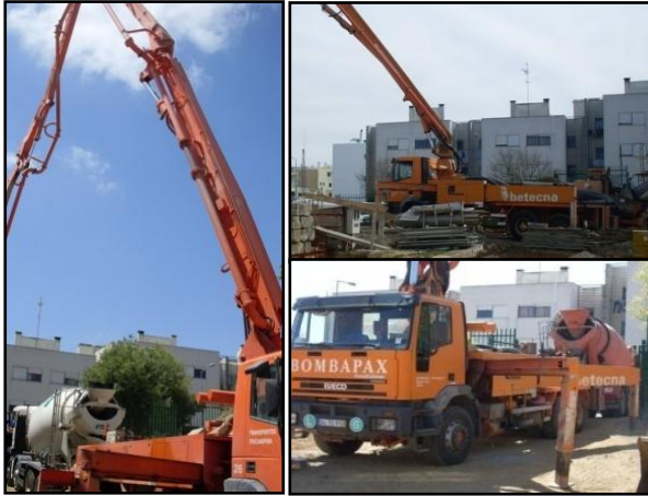
Fig.59 Camião Bomba de betão
