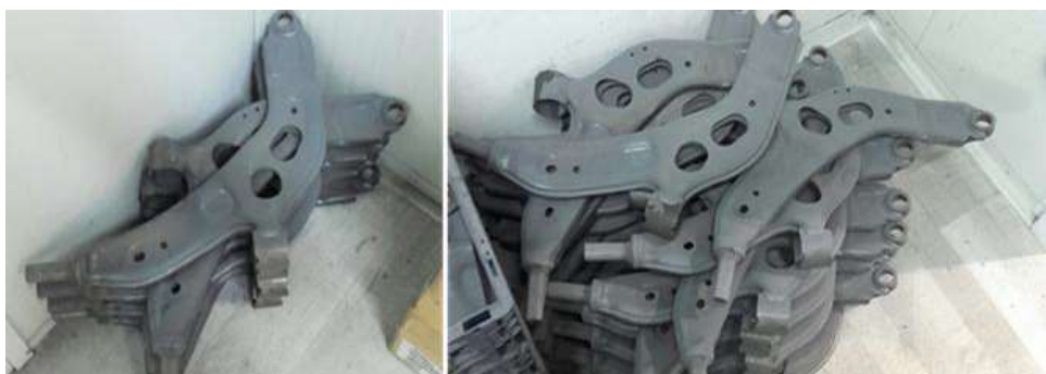
Figura 4. 21 – Acumulação de peças em espera para análise macrográfica.
