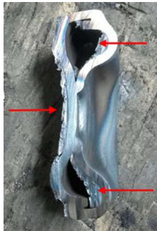
Figura 4. 10 - Morfologia de corte obtida na etapa de Corte Grosseiro.
