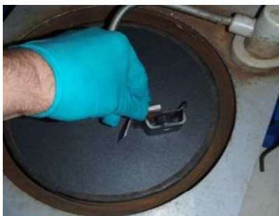
Figura 3. 14 - Execução de um polimento mecânico (cortesia da MCG).
