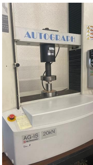
Figura 5 – Compactação de uma mistura na máquina universal de ensaios mecânicos AG-IS da SHIMADZU.
