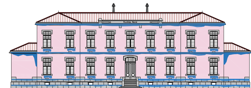
Figura 164. Mapeamento da patologia identificada na Fachada Principal [Fonte: Autora]
