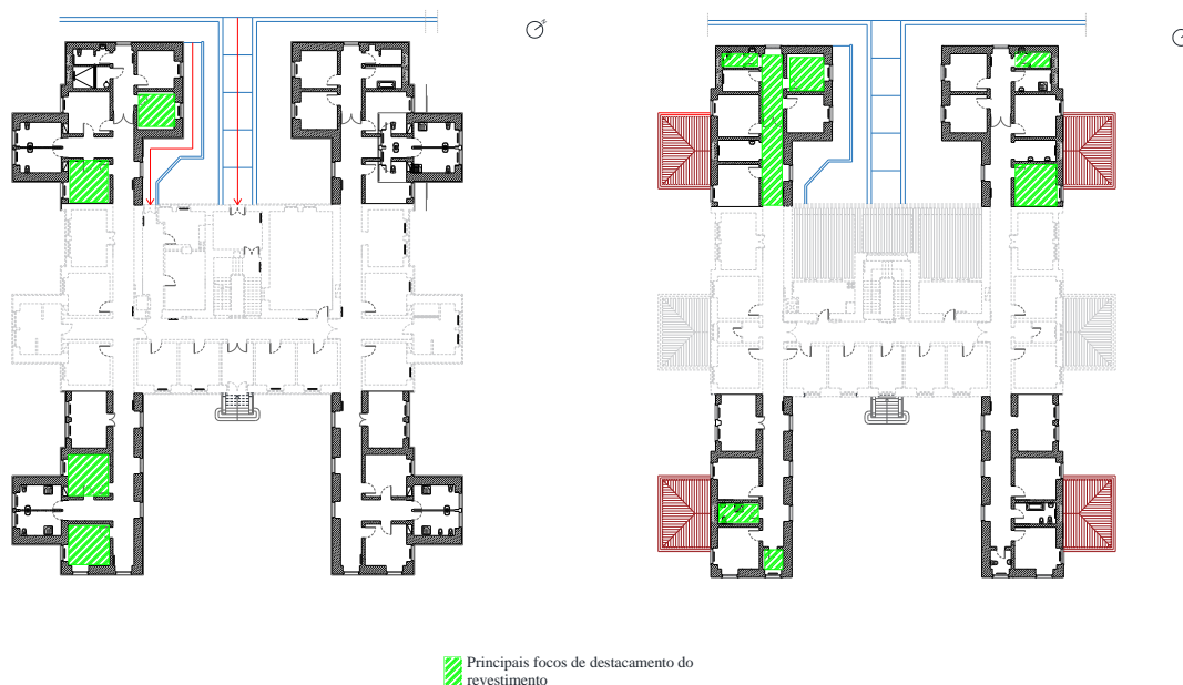
Figura 122. Mapeamento do destacamento do revestimento do teto, no Piso 0 (à esquerda) e no Piso 1 (à direita) [Fonte: Planta Cedida pelo CHPL]
