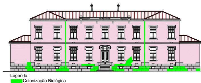
Figura 23. Mapeamento da Patologia na Fachada Principal [Fonte: Autora]
