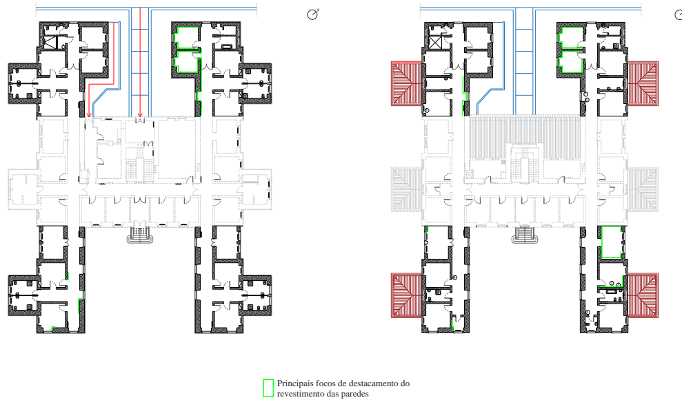
Figura 67. Mapeamento da Patologia identificada no Piso 0 (à esquerda) e no Piso 1 (à direita) [Fonte: Planta Cedida pelo CHPL]
