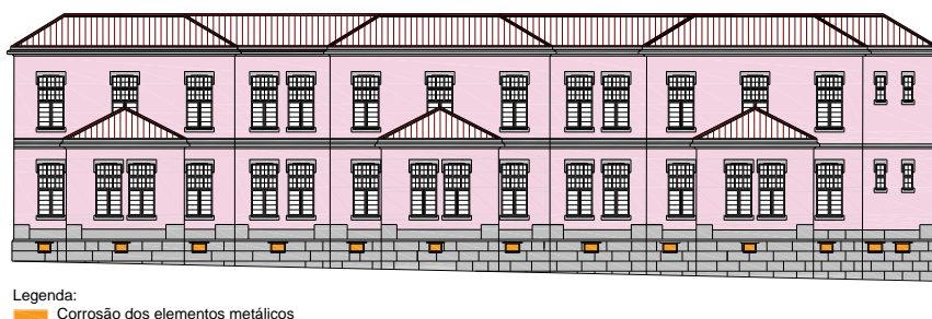
Figura 193. Mapeamento da corrosão nos elementos metálicos na Fachada Lateral Nascente [Fonte: Autora]
