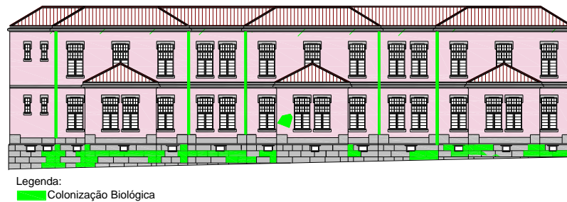
Figura 151. Mapeamento das Patologias, na Fachada Lateral Poente [Fonte: Autora]
