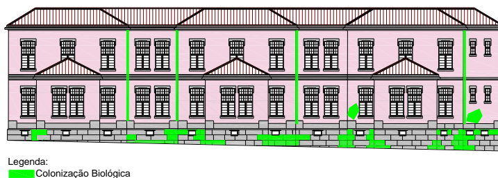
Figura 24. Mapeamento da Patologia na Fachada Lateral Nascente [Fonte: Autora]
