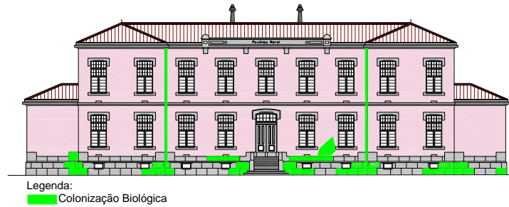
Figura 150. Mapeamento da Patologia na Fachada Principal [Fonte: Autora]
