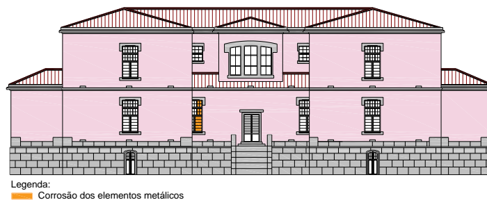
Figura 195. Mapeamento da corrosão nos elementos metálicos na Fachada Lateral Poente [Fonte: Autora]
