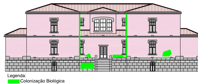
Figura 153. Mapeamento das Patologias na Fachada Posterior [Fonte: Autora]
