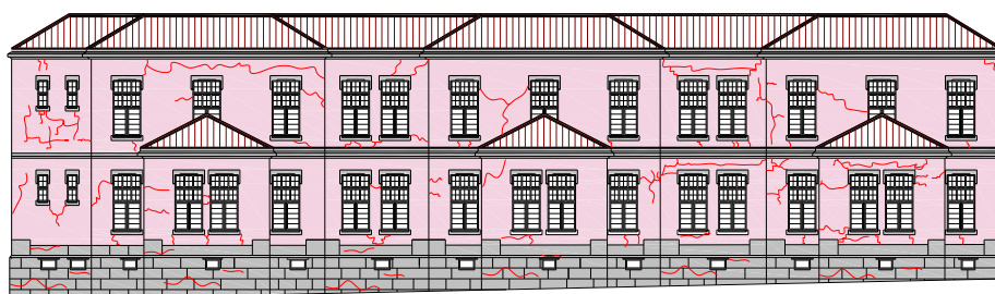
Figura 140. Mapeamento da patologia identificada na Fachada Lateral Poente [Fonte: Autora]
