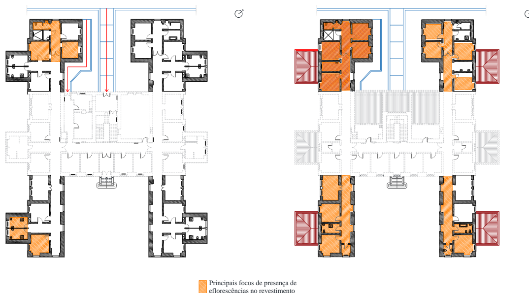
Figura 118. Mapeamento da Patologia no Piso 0 (à esquerda) e no Piso 1 (à direita) [Fonte: planta cedida pelo CHPL]
