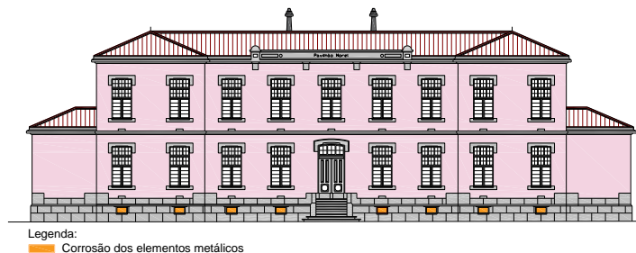
Figura 192. Mapeamento da corrosão nos elementos metálicos na Fachada Principal [Fonte: Autora]
