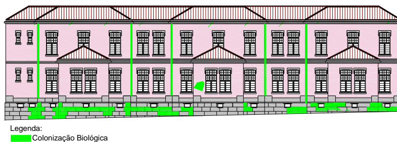
Figura 25. Mapeamento da Patologia na Fachada Lateral Poente [Fonte: Autora]
