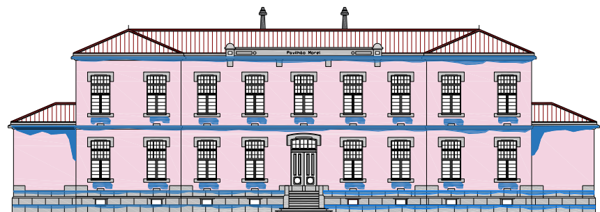
Figura 171. Mapeamento das Patologias na Fachada Principal [Fonte: Autora]
