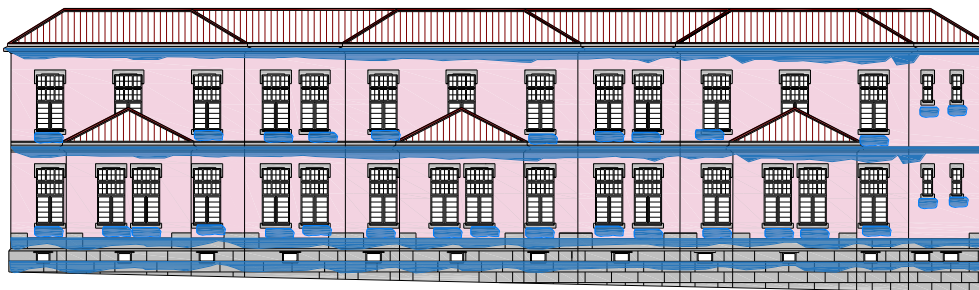
Figura 32. Mapeamento da patologia identificada na Fachada Lateral Nascente [Fonte: Autora]
