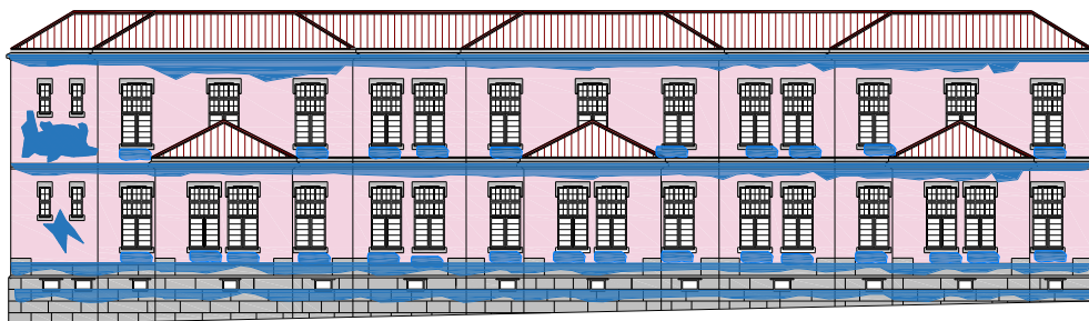
Figura 30. Mapeamento da patologia identificada na Fachada Principal [Fonte: Autora]
