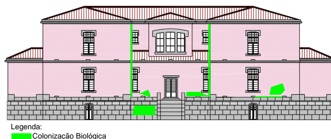
Figura 26. Mapeamento da Patologia na Fachada Lateral Poente [Fonte: Autora]
