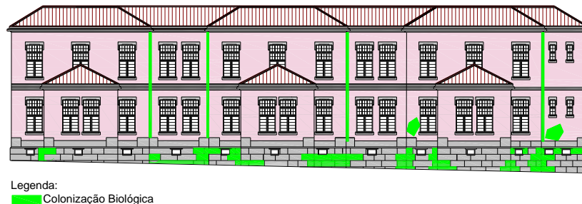
Figura 152. Mapeamento das Patologias, na Fachada Lateral Nascente [Fonte: Autora]
