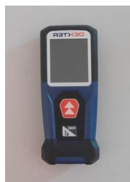
Figura 53- Medidor de distâncias a laser utilizado na inspeção do edifício. Fonte: Autor, outubro 2017.
