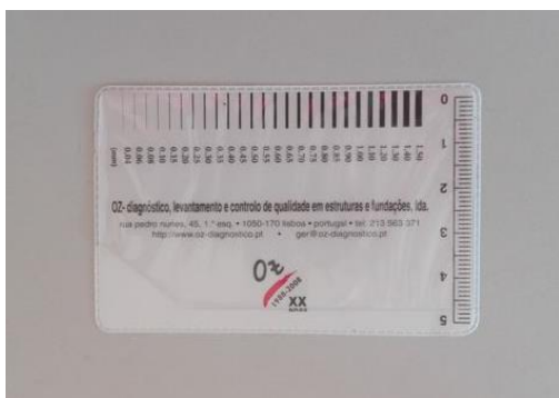
Figura 50-Medidor de fissuras utilizado na inspeção do edifício 31-A. Fonte: Autor, outubro 2017.
