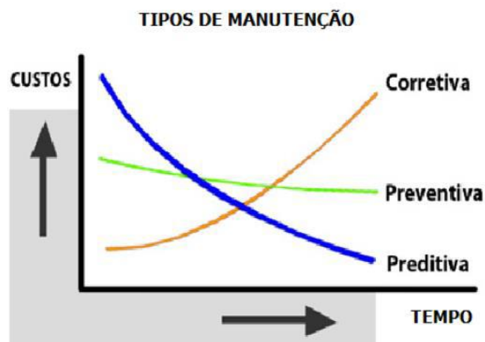
Figura 3.3 - Comparação de custos entre os 3 tipos de manutenção (Fonte: ASSOCIAÇÃO BRASILEIRA DE MANUTENÇÃO (ABRAMAN), S.D.)
