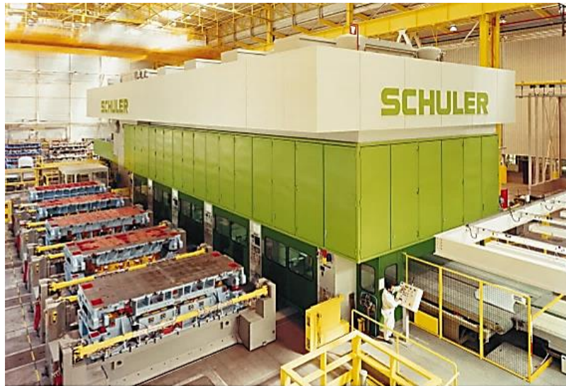
Figura 23 - Prensa com sistema transfer 'crossbar' – Prensa com 5 tetos individuais (Retirada de [4]).
