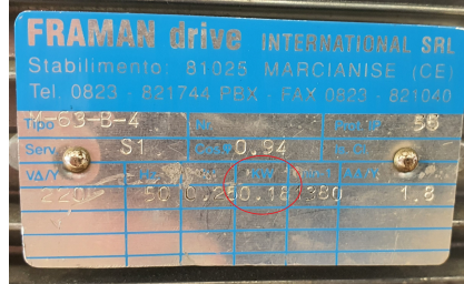
Fig. E.8 - Placa sinalética do motor trifásico
