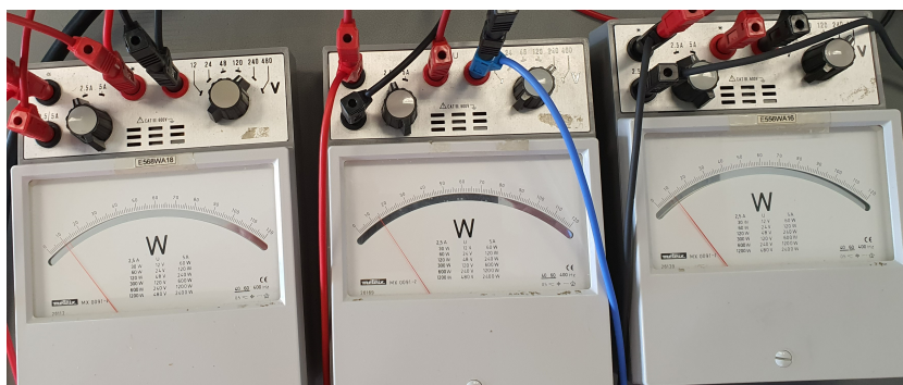
Fig. E.6 – Wattímetro para leitura de potência em cada fase
