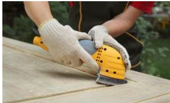
Figura 108 -Aplicação de uma lixadeira numa porta de madeira
