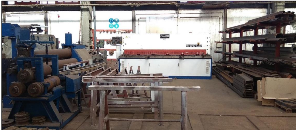
Figura 17 - Secção de caldeiraria: pormenor da guilhotina e calandra
