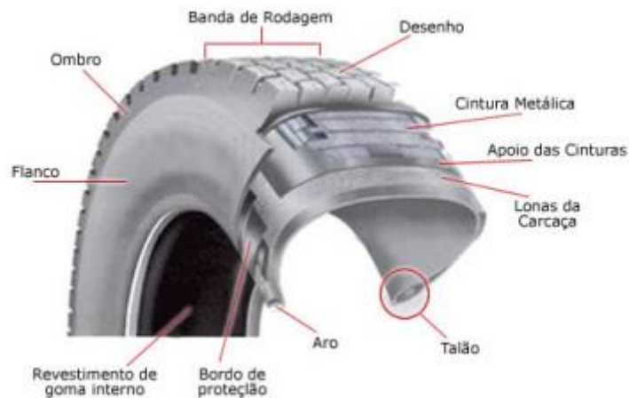
Figura 2.8 - Constituição de um pneu
