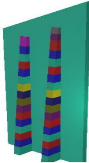
Figura 9 - Modelo tridimensional para muros com altura máxima de consola até 5,50 m, Retirado do programa de cálculo STRAP V12.5
