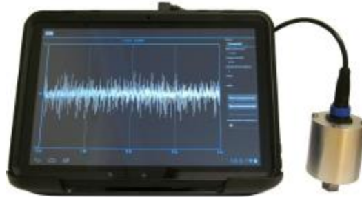
Figura 2.1 – Dispositivo Android com acelerómetro externo ligado e representação do sinal adquirido; [10]
