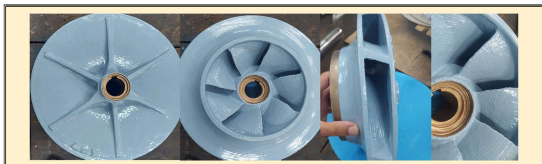
Figura 82 – INSP_05-1 com imagens do revestimento do impulsor
