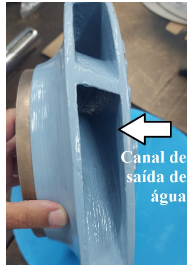
Figura 27 – Impulsor fechado: Canal de saída de água
