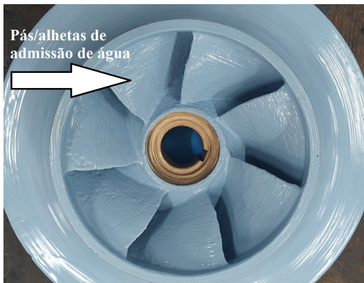
Figura 26 – Impulsor fechado: Pás de entrada de água
