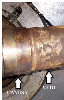
Figura 34 – Veio e camisa onde trabalha o empanque da bomba
