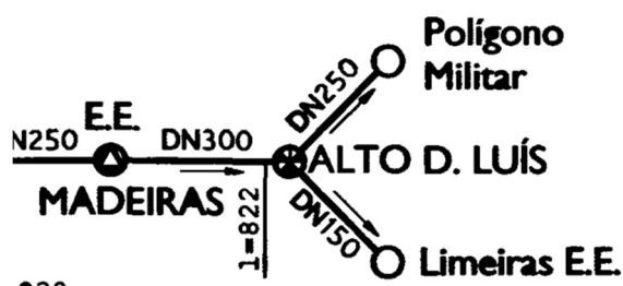
Figura 51 – Representação esquemática do sistema elevatório EE Madeiras – Res. Alto de Dom Luís [34]
