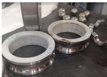
Figura 42 – Pistas interiores de dois rolamentos de esferas do tipo isolado
