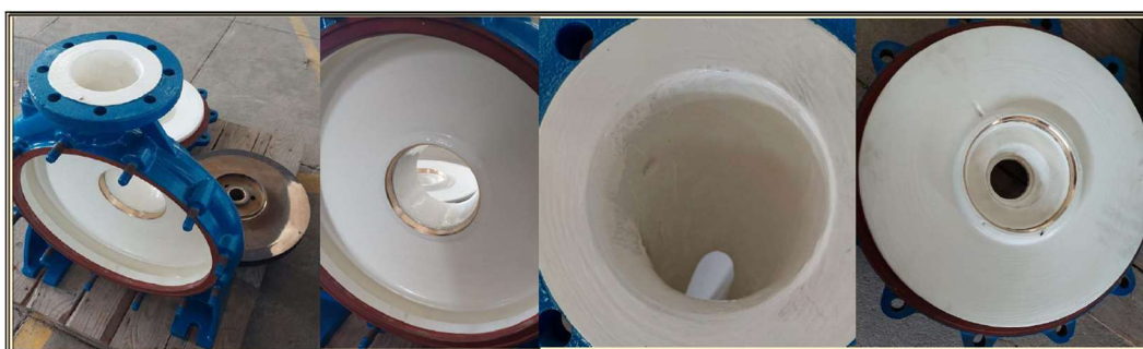
Figura 70 – Registos fotográficos da voluta da bomba após aplicação de revestimento
