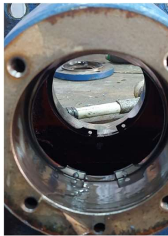
Figura 35 – Caixa de rolamentos aberta, com freios interiores visíveis
