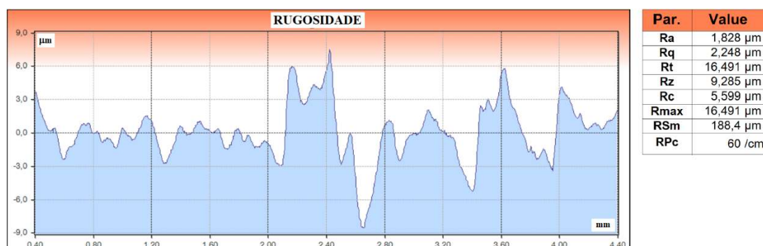
Figura 10 – Perfil de rugosidade obtido com o rugosímetro Tesa Rugosurf 20
