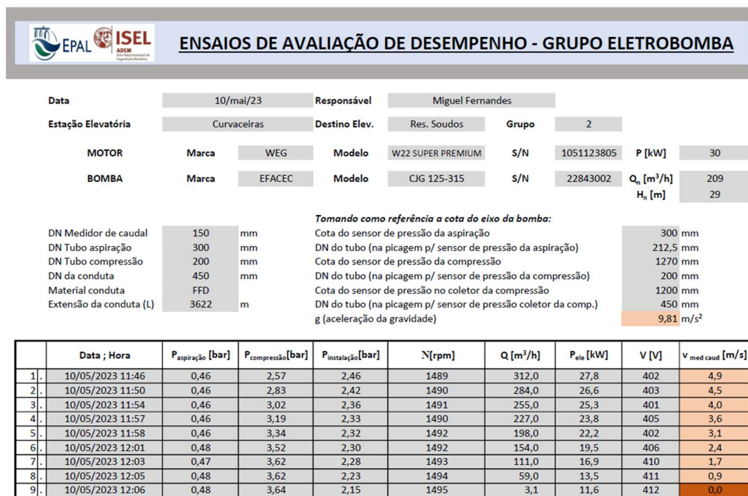
Figura 62 –INSP_03-1- EE Curvaceiras – Soudos: Gr. 2 (após intervenção de manutenção)
