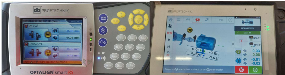
Figura 21 – Alinhadores do tipo Laser num processo de alinhamento
