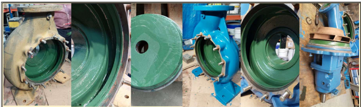
Figura 61 – INSP_05-1 - Avaliação de revestimentos da bomba do Gr. 2 da EE Curvaceiras - Soudos
