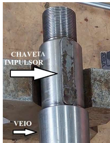
Figura 37 – Extremidade do veio com a chaveta de fixação do impulsor
