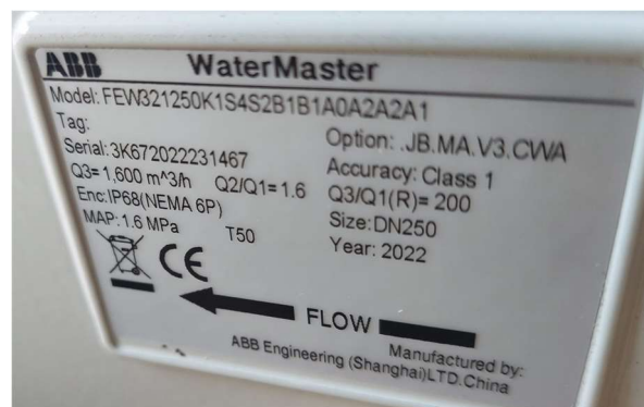
Figura 69 – Chapa de característica do elemento primário do medidor de caudal
