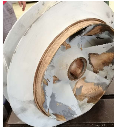
Figura 30 – Impulsor sujeito a desgaste por cavitação (tensão de vapor não foi assegurada)
