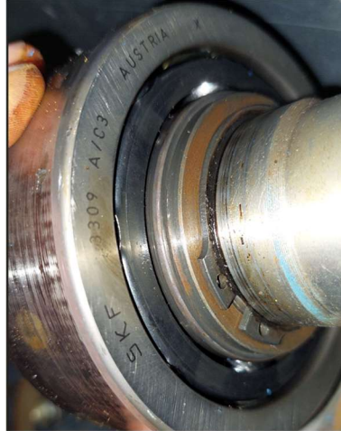
Figura 41 – Rolamento SKF 3309 A/C3 da bomba EFACEC CJG 125/315 S/N 22843002
