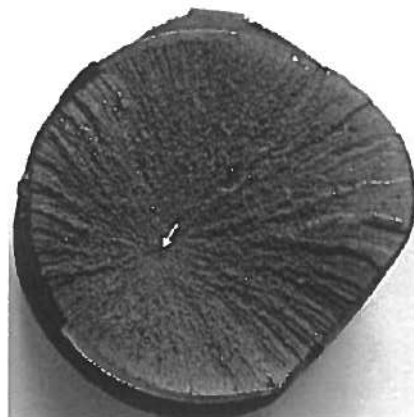
Fig. 6 - Superfície de fratura resultante de ensaio de tração da armadura sob rotura.
