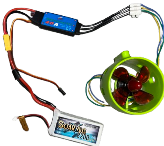
Figura 4.4 Integração elétrica dos propulsores
