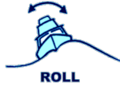
Figura 4.11 Representação do roll numa embarcação (Adaptada de [16])
