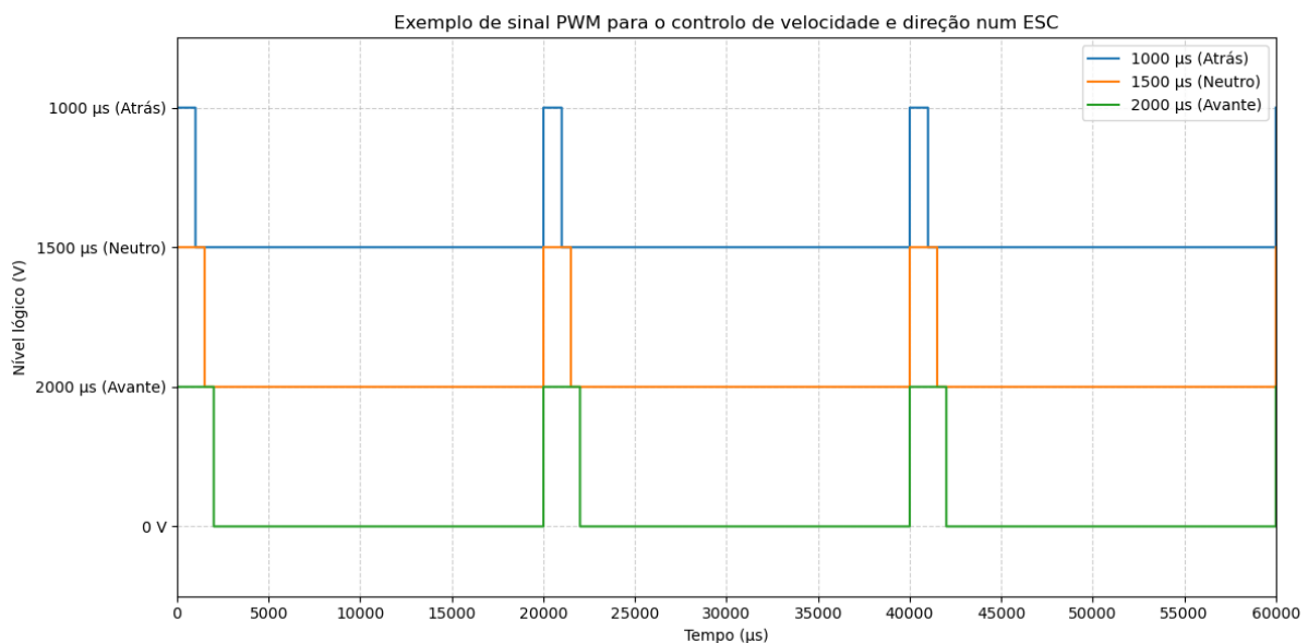
Figura 4.6 Exemplo de sinal PWM para o controlo de velocidade e direção num ESC
