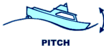
Figura 4.10 Representação do pitch numa embarcação (Adaptada de [16])
