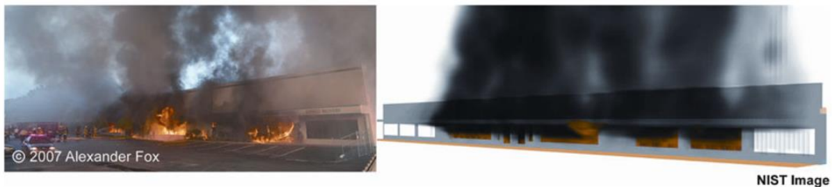
Figura 3.14 – Comparação entre fotografia de um incêndio e respetiva simulação numérica em FDS com visualização em Smokeview [28]
