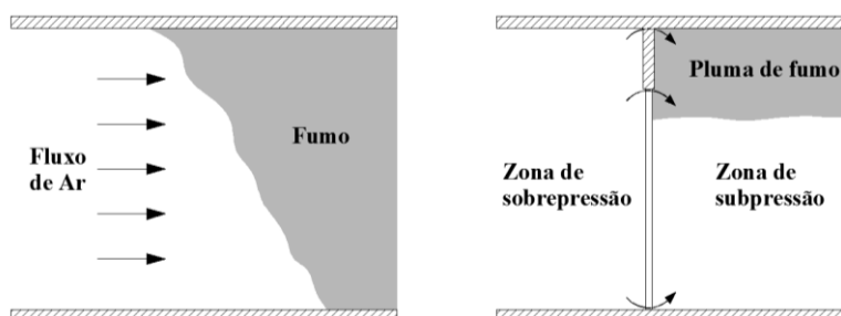
Figura 3.1 – Controlo de fumo – varrimento e hierarquia de pressões (adaptado de [23])
