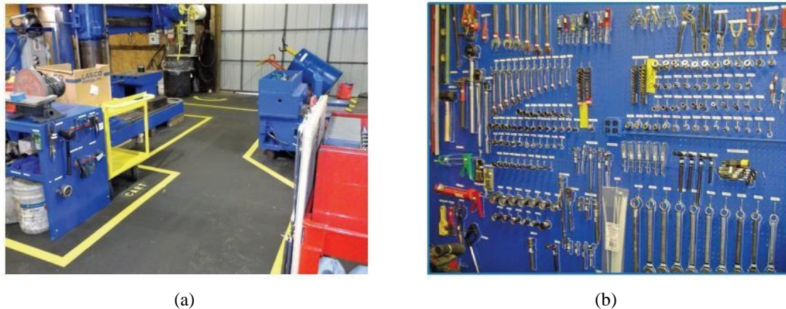
Figura 9 - Exemplos de aplicação do Seiton : (a) Chão marcado com áreas bem delimitadas; (b) Quadro com ferramentas identificadas [16]
