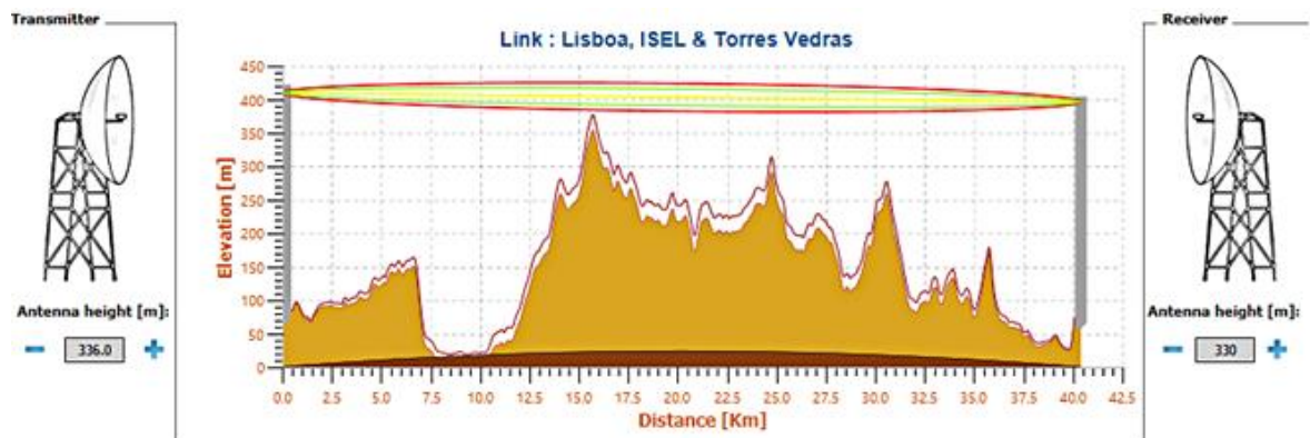
figura 61 - Ligação com altura ideal das torres para alcançar a linha de vista.
