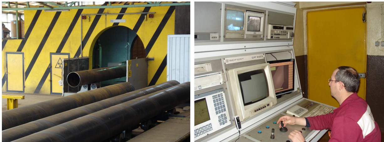
Figura 15 - Execução de controlo radiográfico por fluoroscopia
