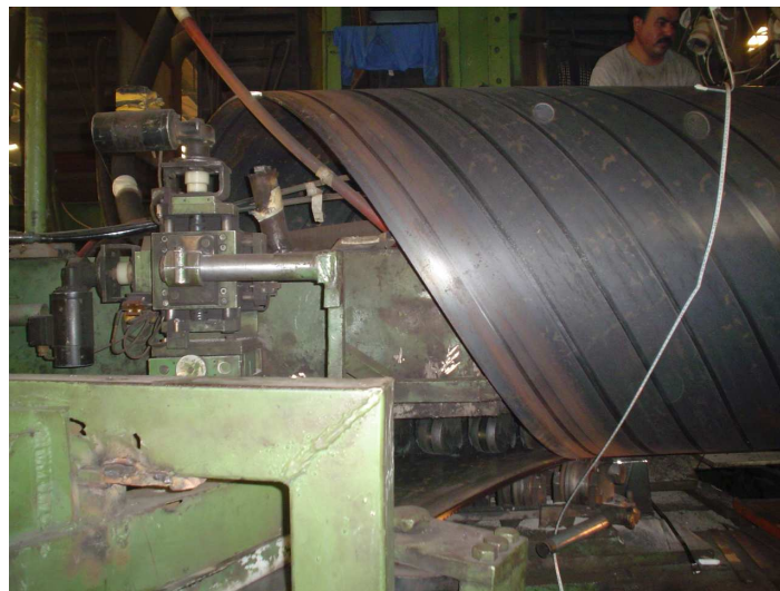
Figura 10 – Deformação plástica de chapa em forma helicoidal para fabrico de tubos
