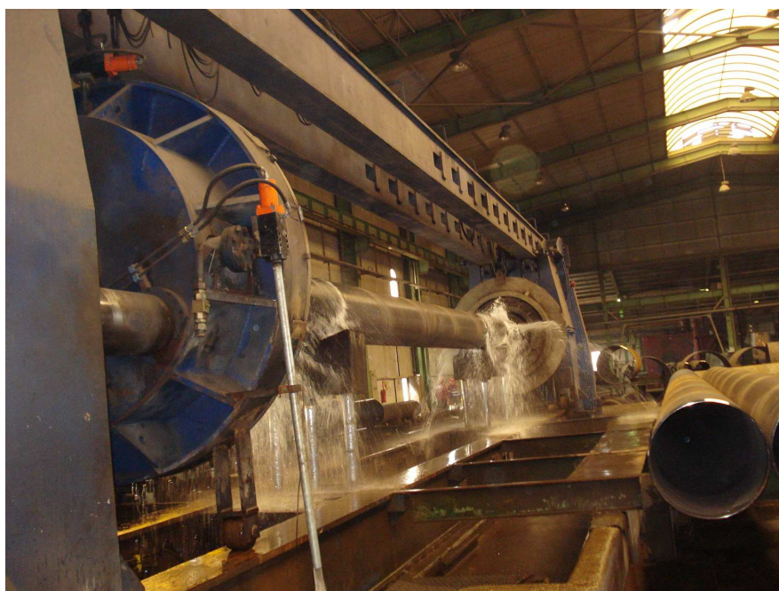
Figura 16 – Realização de ensaio hidrostático em fábrica
