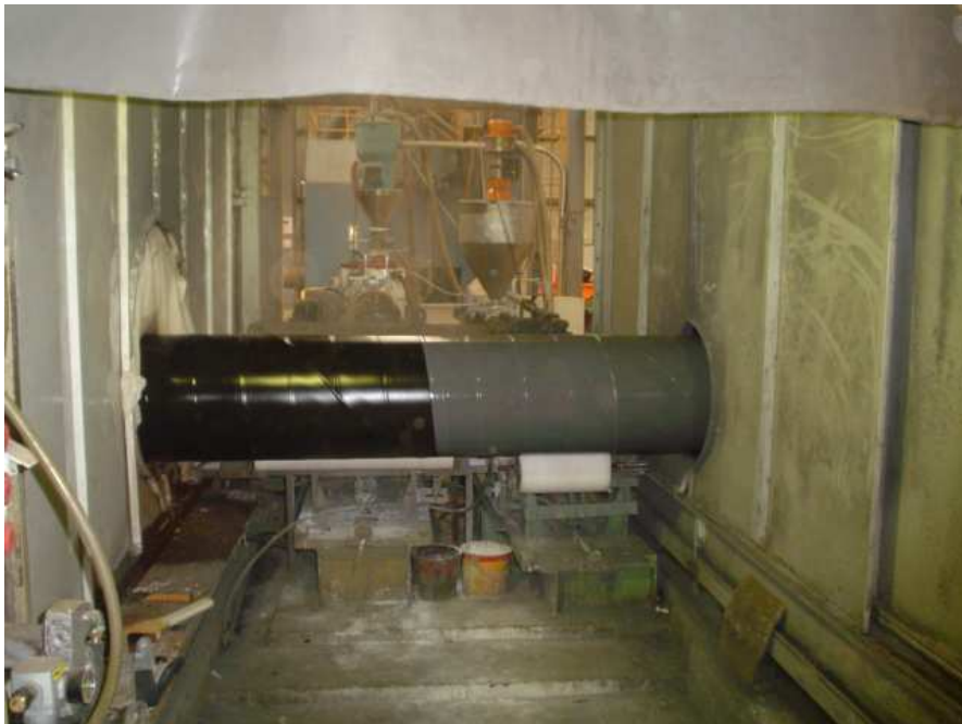
Figura 13 – Aplicação de revestimento externo com PEAD (cor preta) sobre a película adesiva (cor cinza)
