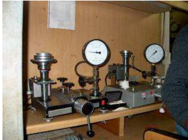
Figura 34 – Execução de ensaio hidráulico a gasoduto com recurso a balança de pesos mortos
