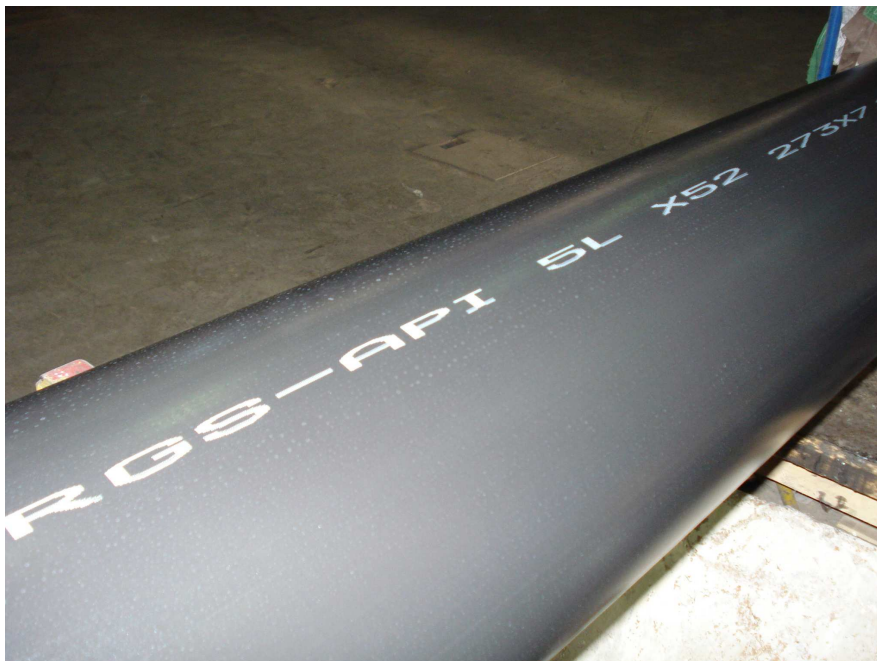
Figura 17 – Exemplo de marcação de um tubo à saída da fábrica
