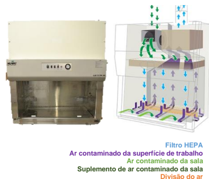
Figura 2.6 - Câmara de fluxo laminar tipo A/B3 Classe II (Fonte: NUAIRE).
