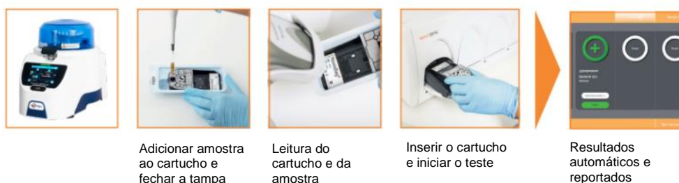
Figura 2.52 - Procedimento aplicado no equipamento MicroArray (Fonte: Hologic).
