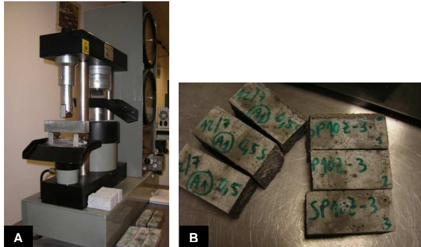
Figura 3.17 – Equipamento de ensaio para determinar resistência dos provetes à flexão (A) e provetes depois de ensaiados (B).
