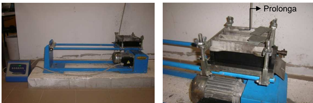
Figura 3.13 – Compactador dos provetes, com prolonga que é colocada no compactador.
