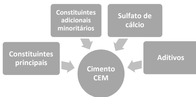
Figura 2.5 – Constituintes de um cimento CEM.
