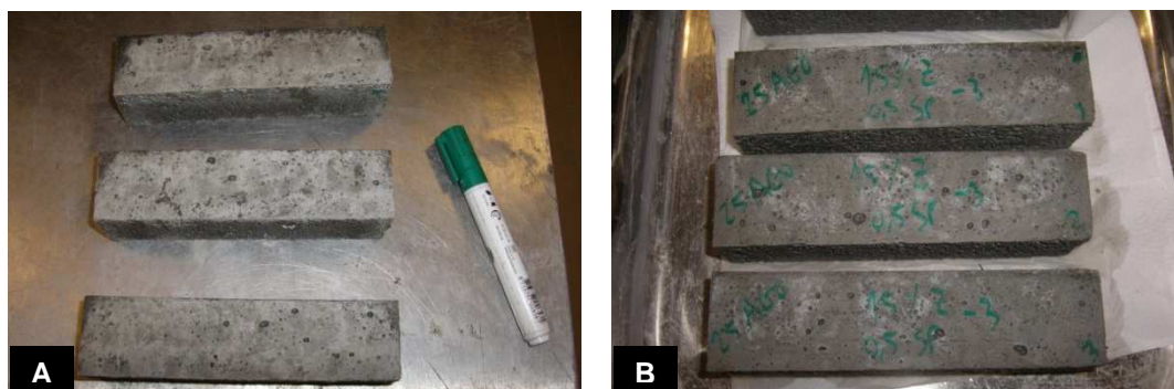
Figura 3.14 – Provetes depois de desmoldados (A e B) e identificados (B).
