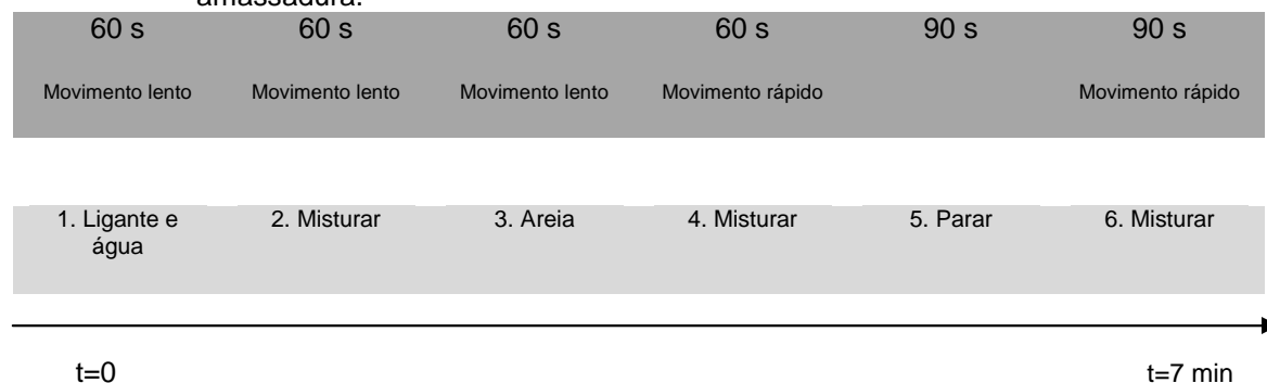
Figura 3.6 – Esquema dos tempos e sequência de introdução dos constituintes, em cada amassadura.
