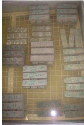
Figura 3.15 – Armazenagem dos provetes em água.
