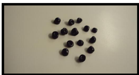
Figura 6 - Polietileno utilizado, cerca de 2,2g por amostra (a ficha técnica do produto encontra-se no anexo B)
