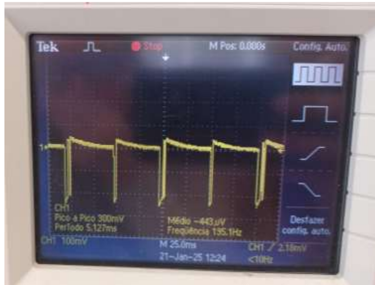
Figura 39 - Frequência de amostragem GY53 VL53L0X (Fonte própria)
