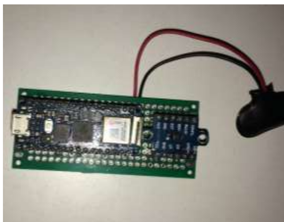
Figura 32 - Versão do dispositivo com o Arduino Nano RP2040 e o sensor GY53 VL53L0X
