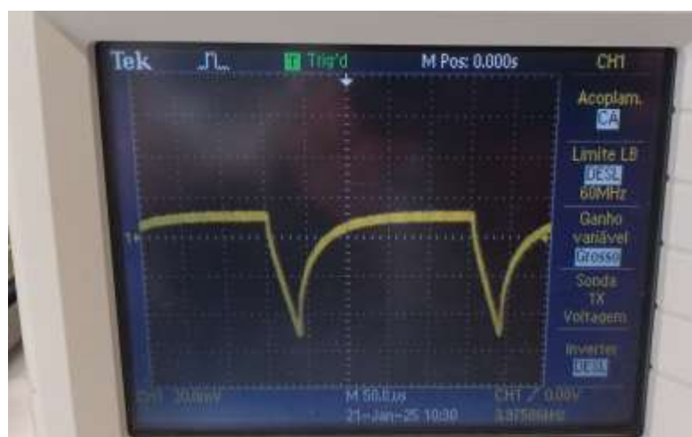
Figura 38 - Frequência de amostragem TF mini S LiDAR (Fonte própria)
