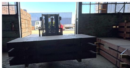
Figura 4.12 – Levantamento das travessas no local de armazenamento e seu deslocamento para o exterior
