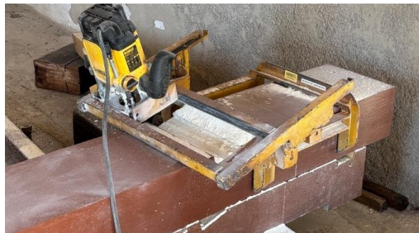
Figura 4.23 – Tupia elétrica montada sobre gabarito metálico
