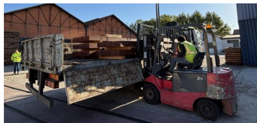
Figura 4.13 – Transporte das travessas entre o armazém e o camião-grua e sua colocação neste
