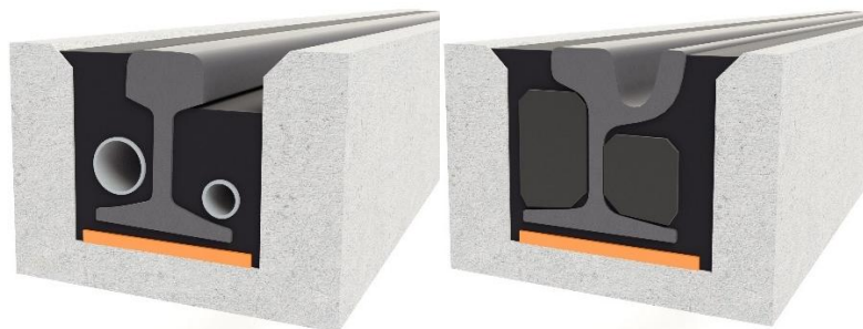
Figura 2.35 – Sistema Edilon, em carril de vignole e em carril de gola (Edilon Sedra, sem data)
