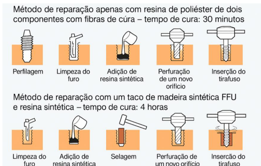
Figura 3.13 – Método de reparação das Travessas FFU (SEKISUI, 2020)
