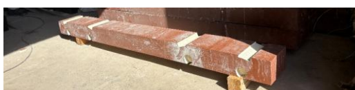
Figura 4.25 – Travessa sabotada para receber as cantoneiras metálicas
