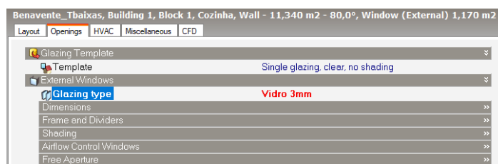
Figura 3.9 Superfície envidraçada simples 3mm, cozinha DesignBuilder
