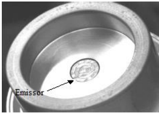
Figura 5.11: Detalhe do cátodo. Emissor de elétrons com 5 mm de diâmetro de Tungstênio, adaptado (Schardt et al., 2004).
