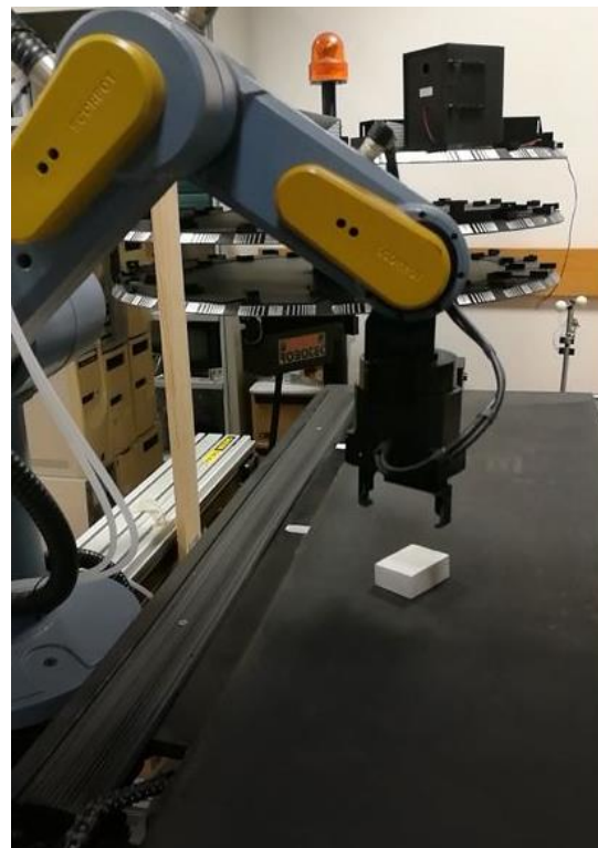
Figura 92. Peça em posição final e robot a realizar o movimento de captura
