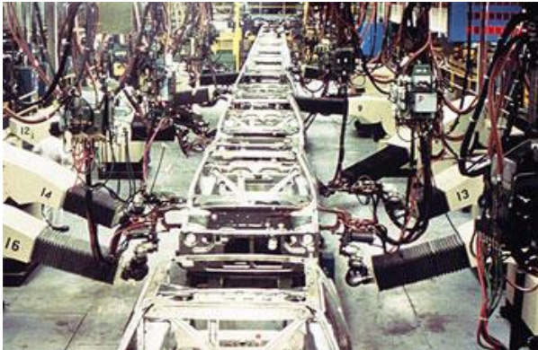
Figura 5. Linha de produção com o Robot Unimate [8]
