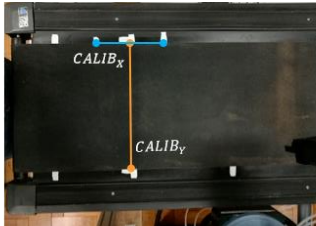
Figura 59. Marcação de pontos no transportador para calibração
