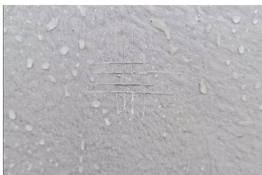
Figura 5-23 Ensaio de quadrícula nas superfícies de betão.
