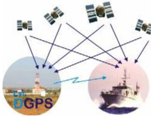
Figura 6: Esquema de funcionamento do DGPS [27]
