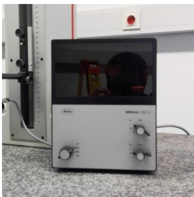
Figura 7- Comparador digital (esquerda) e coluna de medição (direita)
