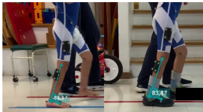
Figura 5.15 Dorsiflexão máxima na fase de apoio do membro inferior direito sem AFO (à esquerda) e com AFO (à direita) T.N.
