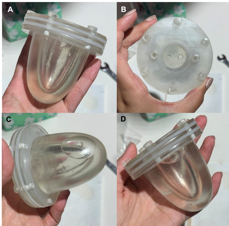
Figura 4.14. Fantoma Final com a cavidade do Miocárdio preenchida com água. Posteriormente o fantoma foi preenchido com soro contendo o radioisótopo, estando pronto a ser testado.
